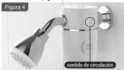
El conector de giro libre permite posicionar perfectamente el equipo sin ajustar de más. En caso de presiones mayores a 4,0kg/cm<sup>2</sup>, reemplazar el conector de giro libre por el Limitador Automático de Presión (LAP Ducha II).
