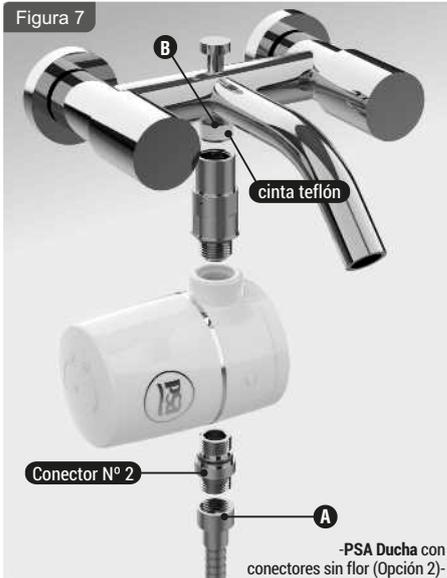
6. Colocar el Conector N°2 (adaptador M-M) en el otro extremo, verificando de enroscar correctamente la parte que incluye el O´ring hacia el PSA Ducha II.
